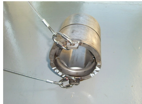
200 t 落下防止ワイヤー取付状況
