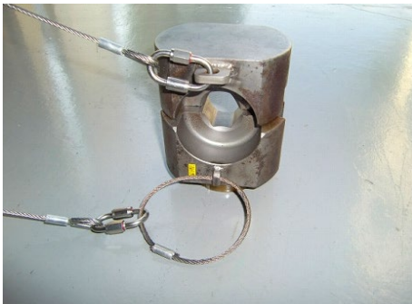
100 t 落下防止ワイヤー取付状況
