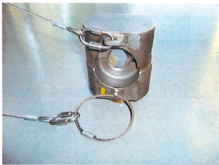
100 t 落下防止ワイヤー取付状況
