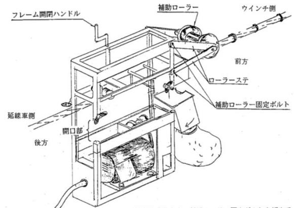
開梱しましたら、補助ローラー固定ボルトを緩めてローラーステを図のように取付け直して下さい。
