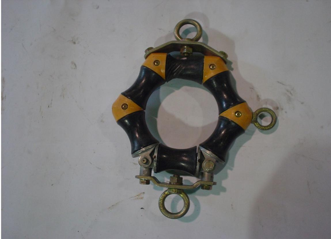
吊金工法：この工法は鉄道、高速道路、高圧線、民家、河川等の重要横断箇所の足場なし工法として広く採用されている。
