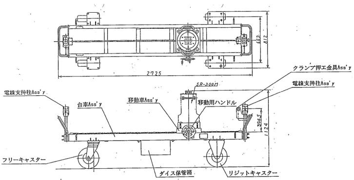
特 長 送電線の大容量化に伴い、益々大型化するヘッド、電線での圧縮作業の省力化を図るため開発され、容易確実に圧縮作業が行える
