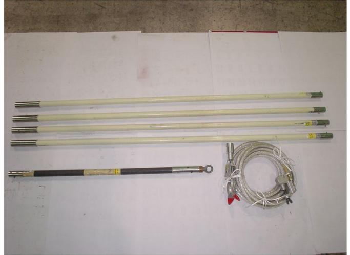
希望電機製の接地棒(伸縮式)
