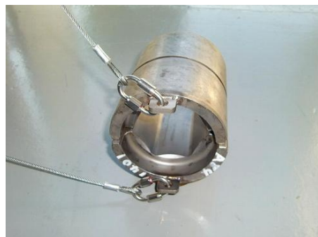
200 t 落下防止ワイヤー取付状況
