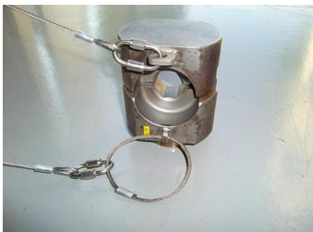
100 t 落下防止ワイヤー取付状況
